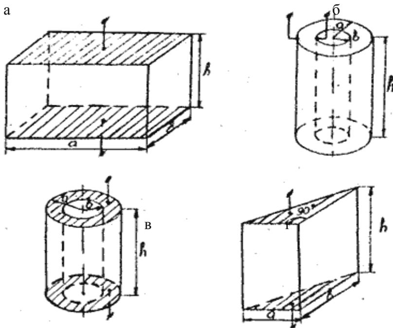
Рисунок 2 Формы диэлектриков:
